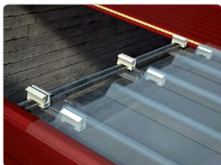
SUPRAPUNERE - A 2-A FAZĂ Montajul sub presiune a plăcii de jos
